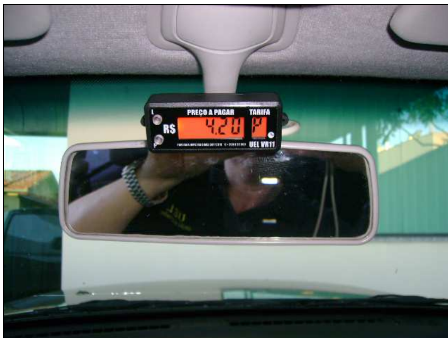
Instalado no retrovisor. O cabo foi colocado na fresta existente entre o forro e o teto.
