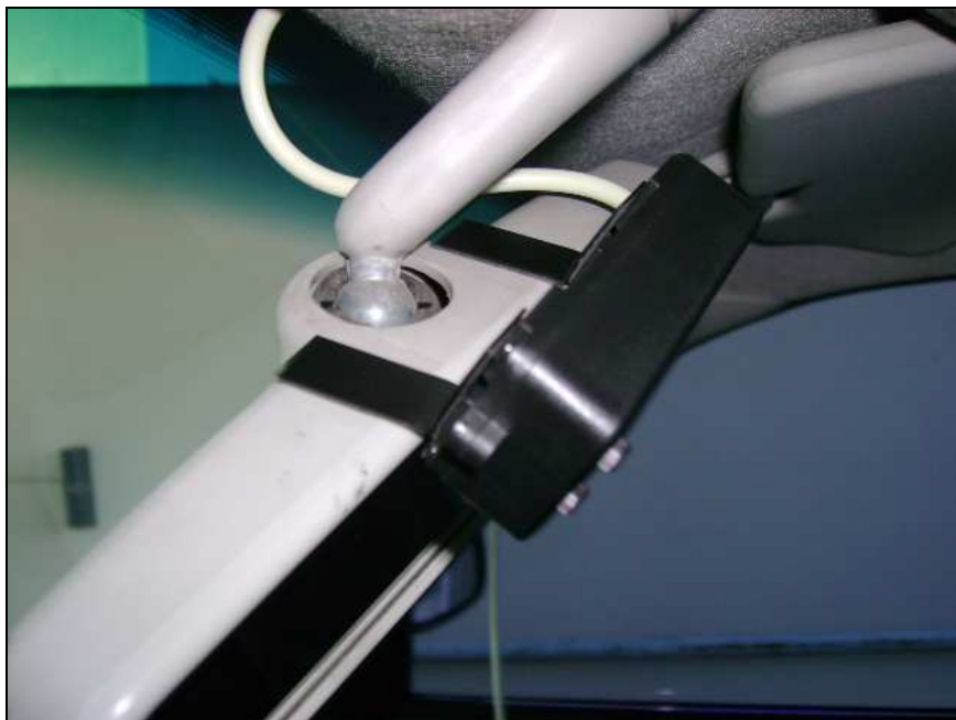
VR11 instalado no retrovisor. O cabo foi colocado na fresta existente entre o forro e o teto.
